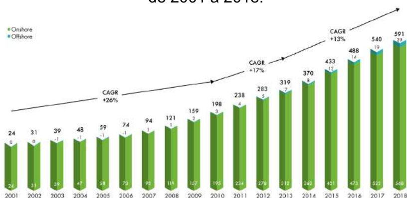
Figura 1.1 – Evolução da capacidade instalada de geração eólica no mundo (GW) de 2001 a 2018.
